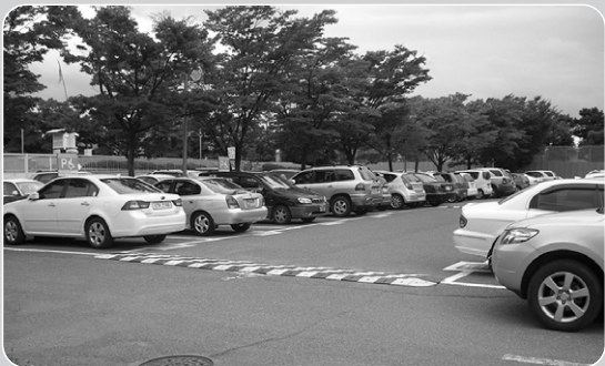
〈사진 2〉 장애인주차구역 주출입구(문) 및 승강설비에 최단거리에 설치되어야 하는 장애인주차구역이지만 주출입구까지와의 거리는 상당히 멀었으며 차량과의 간섭도 많았다.
