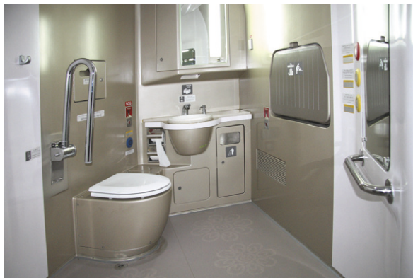
장애인전용화장실은 남녀 구분 없이 1실만 제작됐고, 대변기 손잡이는 규정에 어긋나게 설치됐다.
